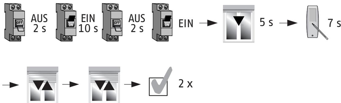
Schalten Sie die Netzspannung für 2 sec. aus, dann wieder für 10 sec. ein, nochmals 2 sec. aus und anschließend wieder ein. Der Empfänger bestätigt mit einer 5 sec.-Bewegung. Drücken Sie nun für 5 sec. die PROGRAMMIERTASTE, der Empfänger bestätigt mit zweimal AUF-AB.
