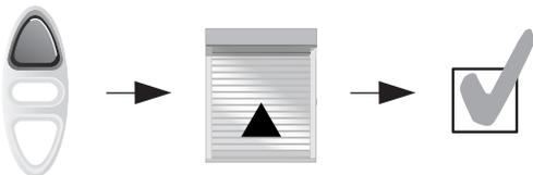
Drücken Sie AUF und der Behang fährt nach unten, so müssen Sie die Drehrichtung ändern. Drücken Sie hierzu mind. 5 sec. auf STOPP, der Empfänger bestätigt mit einer kurzen AUF/AB-Bewegung.
