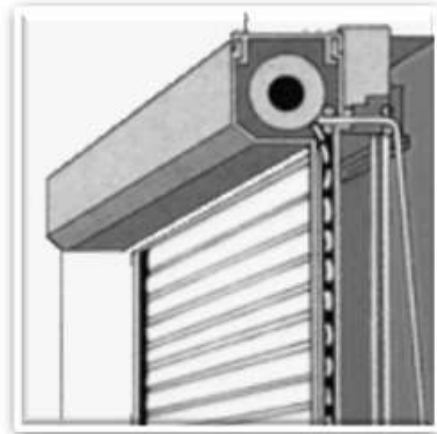
Funktionsweise eines Vorbaurolladens - Linksroller
