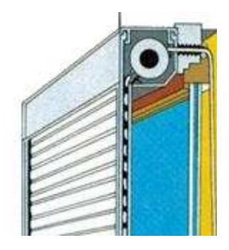
Bedingt durch das Wickelverhalten der gewölbten Rolladenstäbe kann der Rolladen nur in einer Richtung auf der Welle aufgewickelt werden.
