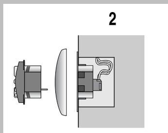
2. Centralis IB zusammen mit dem Abdeckrahmen in den Steckrahmen stecken.
