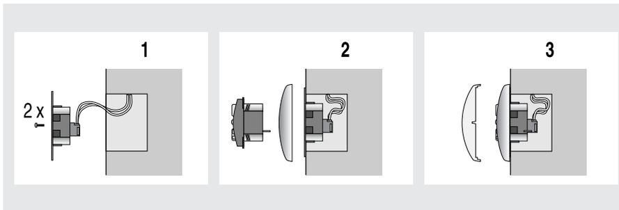
1.) Anschlussleitungen an den Klemmen des Tragrahmens anschließen (Klemmenbelegung siehe Kap. 5.2) und Tragrahmen in U.P.-Dose befestigen.
