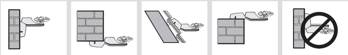
Der Eolis Sensor RTS kann durch das verstellbare Gelenk an alle Montagesituationen angepaßt werden.
