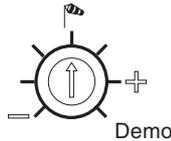
Der Windschwellwert kann anhand des Potentiometers
