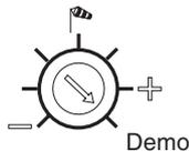
Zum Test und zur Demonstration der Steuerfunktionen ist es möglich die Reaktionszeiten des Eolis Sensor RTS auf wenige Sekunden zu verkürzen.
