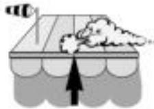
Wenn die Windgeschwindigkeit den am
