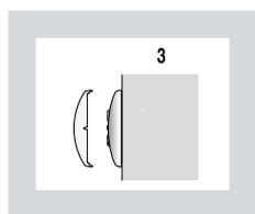
3.) Schutzfolie vom Display abziehen. Abdeckplatte aufdrücken.
