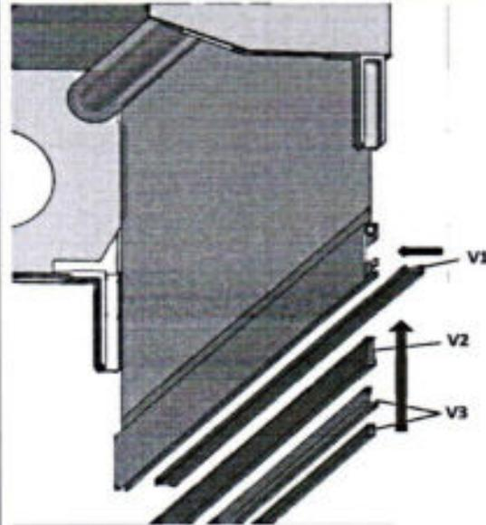
Bürstenkeder je nach Variante in die entsprechende Nut der SL-I.2 oder Teleskopprofil einziehen. Untere Bürsten sollten mit Kleber fixiert werden.
