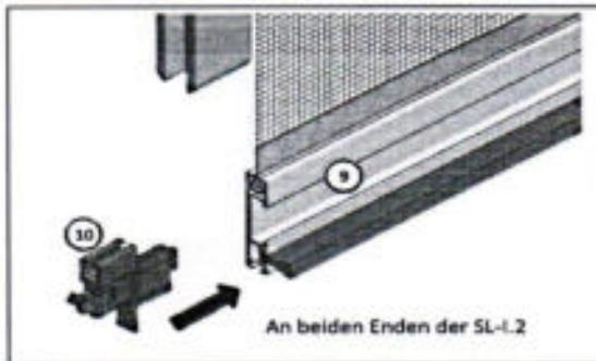
▪ **Montage der Easy-Click.2 Endstück in der Führungsschiene A 20**
