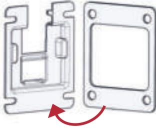
**Dichtrahmen auf Gurtführung kleben. Zweite Schutzfolie belassen.**
