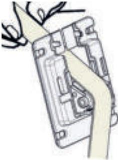
**Gurt einfädeln und Gurtführung über dem Gurtauslass ausrichten.**
