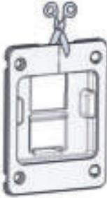
**Dichtrahmen einschneiden um den Gurt einzufädeln.**
