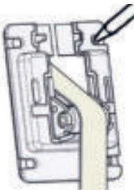
**Schraubposition anzeichnen und ggf. Löcher bohren.**
