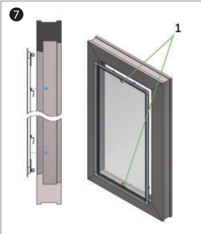
Der Rahmen wird außen an der Oberfläche des Fensters montiert. Er wird in die Fensteröffnung des Fensterrahmens eingehängt.
