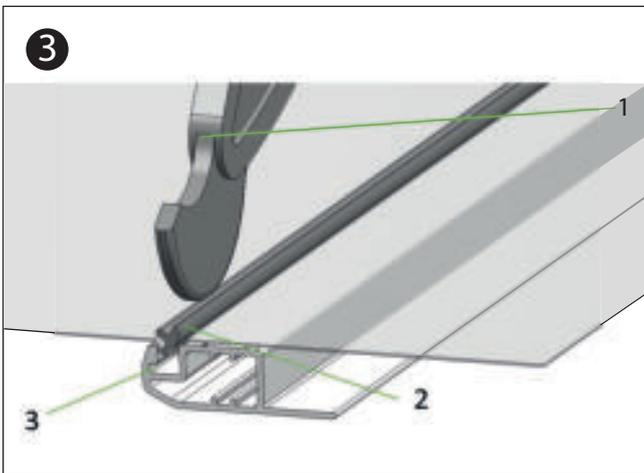
Den Gummikeder (2) mit dem Kederwerkzeug (1) in die Kedergasse (3) des Aluminiumprofils hineindrücken.
