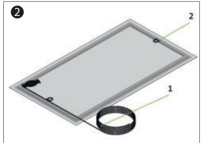
Das Netz über den Rahmen ausbreiten. Anschließend die Griffflaschen (2) mit dem Netz in der Kedergasse des Aluminiumprofils hineindrücken. Danach den Gummikeder (1) über die Kedergasse des Aluminiumprofils auslegen.
