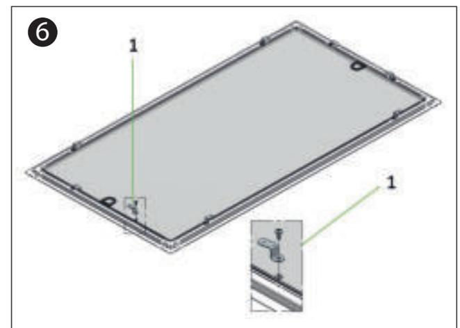
Optional - die Drehhaken (1) montieren. Bis zur Drehhakengröße von 25 mm werden die Haken vernietet. Bei größeren Größen liegen die Haken aus Gründen des Transportschutzes lose bei und müssen bauseits verschraubt werden.
