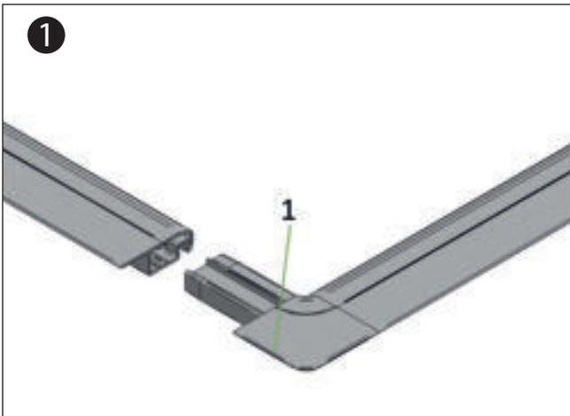
Die Aluminiumprofile und die Eckverbindungsstücke (1) zu einem kompletten Rahmen zusammenstecken.
