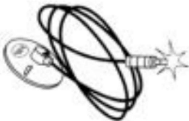
Ein Lichtleiter misst sowohl die einfallenden Sonnenstrahlen als auch den Dämmerungszustand am Abend. Bei intensiver Sonneneinstrahlung senkt sich der Rollladen bis zum Sensor. Bei Dämmerungsfunktion wird der Befehl zum Senken bei Erreichen der Dämmerung gegeben. Die Werte für den gewünschten Sonnen- bzw. Dämmerungszustand können über Justierschrauben und mit Hilfe entsprechender Symbole am Gerät verändert werden.
