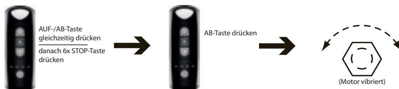
Der Motor fährt nun nur, solange Sie die AUF- oder AB-Taste gedrückt halten. Beim Modus Tippbetrieb drücken Sie die AUF- oder AB-Taste 3 Sekunden lang, somit fährt der Motor bis zum Endpunkt oder bis Sie die STOP-Taste drücken.
