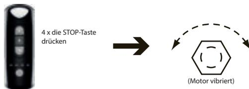
3. Die Zwischenposition kann nun angefahren werden, indem Sie für 5 Sekunden auf die STOP-Taste drücken.
