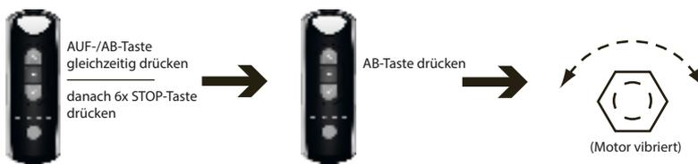
Der Motor fährt nun, solange Sie die AUF- oder AB-Taste gedrückt halten. Beim Modus Tipp-Betrieb, drücken Sie die AUF- oder AB-Taste für 3 Sekunden. Der Motor fährt bis zum Endpunkt oder bis Sie die STOP-Taste drücken.
