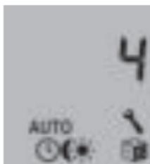
Mit den Tasten ↑ und ↓ den Menüpunkt „4“ ☀ (Sonnenautomatik) auswählen und die Auswahl mit der Taste „OK“ bestätigen.
