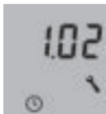
Mit den Tasten  $\uparrow$  und  $\downarrow$  kann das Datum eingestellt werden. Wird eine der Tasten gehalten, geschieht die Verstellung in ansteigender Geschwindigkeit.
