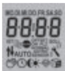
Um die Steuerung auf den Auslieferungszustand zurückzusetzen, müssen alle vier Tasten (↑, ↓, „M“ und „OK“) zugleich für 5 Sekunden gedrückt werden bis die Anzeige sämtliche Symbole anzeigt.
