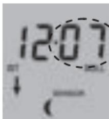
Steht ein angeschlossener SD-Sensor zur Verfügung und wurde für die Schaltzeit „Ab“ der Modus „SENSOR“ ausgewählt, ist eine Anpassung des Dämmerungsgrenzwertes möglich. Links wird der aktuelle Messwert angezeigt (IST).
