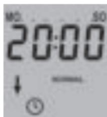
Wurde für die Schaltzeit „Ab“ der Modus „ASTRO“ ausgewählt, ist eine Anpassung der berechneten Dämmerung von -60 bis +60 Minuten möglich (Offset). Bei negativem Offset wird die Dämmerung früher, bei positivem Offset später ausgeführt.
