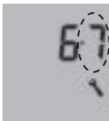
Mit den Tasten  $\uparrow$  und  $\downarrow$  den Menüpunkt „6.7“ (Softwareversion anzeigen) auswählen und die Auswahl mit der Taste „OK“ bestätigen.
