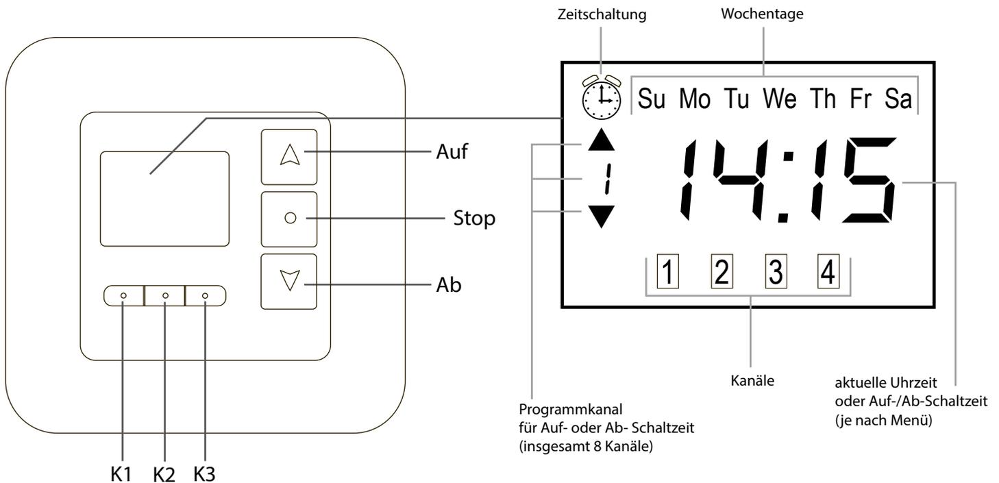
Mit der 4-Kanal Zeitschaltuhr können bis zu 4 Rollladenmotoren manuell sowie zeitlich in einer Gruppe oder einzeln gesteuert werden.
