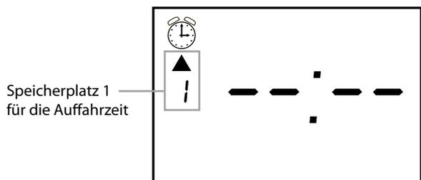
2. Durch Betätigen der Taste K2 schalten Sie die einzelnen Speicherplätze durch. (Die Pfeile auf der Linken Seite des Display signalisieren ob es sich um eine Auf- oder Abfahrzeit handelt)
