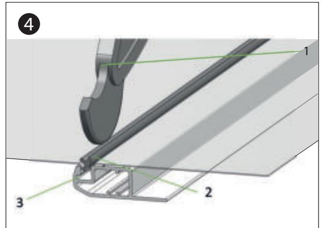
Den Gummikeder (2) mit dem Kederwerkzeug (1) in die Kedergasse (3) des Aluminiumprofils hineindrücken.
