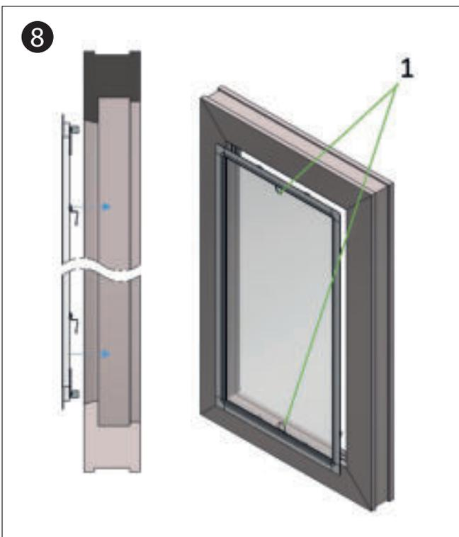
Der Rahmen wird außen an der Oberfläche des Fensters montiert.
