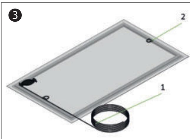
Das Netz über den Rahmen ausbreiten. Anschließend die Griffaschen (2) mit dem Netz in die Kedergasse des Aluminiumprofils hineindrücken. Danach den Gummikeder (1) über die Kedergasse des Aluminiumprofils auslegen.
