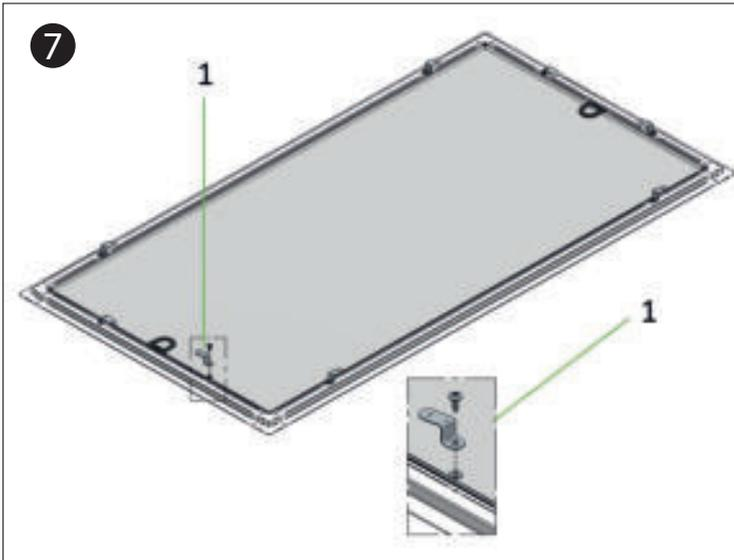
Die Schrauben (1) montieren.
