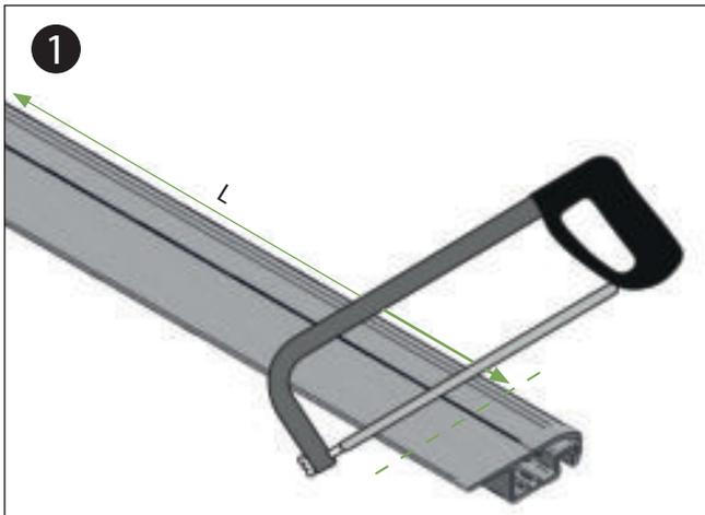
Mit einer Säge die Aluminiumprofile auf die ermittelten Schnittmaße kürzen.
