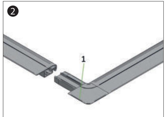
Die Aluminiumprofile und die Eckverbindungsstücke (1) zu einem kompletten Rahmen zusammenstecken.
