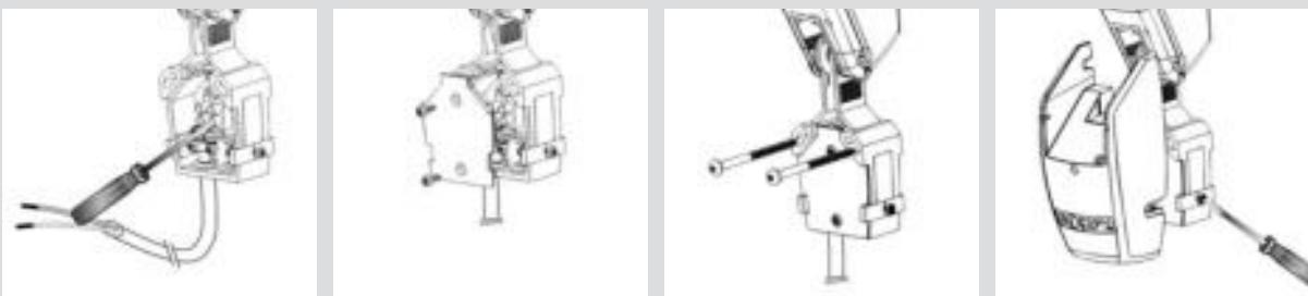
Die Anschlußleitungen werden entsprechend der Klemmenbelegung angeschlossen.
