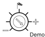
Zum Test und zur Demonstration der Steuerfunktionen ist es möglich die Reaktionszeiten des Soliris Sensor RTS auf wenige Sekunden zu verkürzen. **Wind** auf **Demo** stellen.
