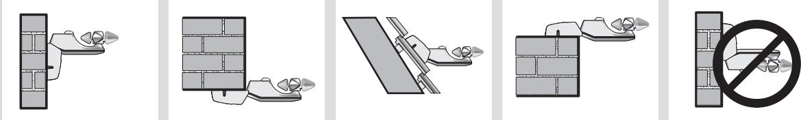
Der Soliris Sensor RTS kann durch das verstellbare Gelenk an alle Montagesituationen angepaßt werden.
